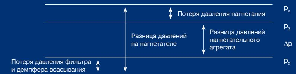
$p_s$  – давление на всасывающем фланце нагнетателя, меньше атмосферного давления на величину потери давления на фильтровальном вкладыше и в демпфере всасывания
